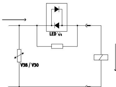
Jede Magnetspule ist mit einer Schutzbeschaltung zur Funkenlöschung und gegen Verpolung gesichert.
