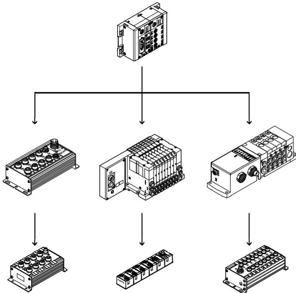
Ventilinsel für Installationssystem CPI:
