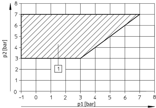
1 Arbeitsbereich für Ventile mit Steuerluftversorgung, extern
