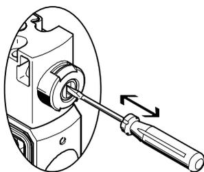
HHB wird durch Drücken mit Stift oder Schraubendreher betätigt und über Federkraft zurückgestellt.
