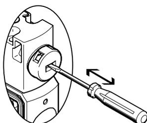
HHB wird durch Drücken mit Stift oder Schraubendreher betätigt und über Federkraft zurückgestellt (rastende Stellung wird durch codierte Abdeckkappe verhindert).
