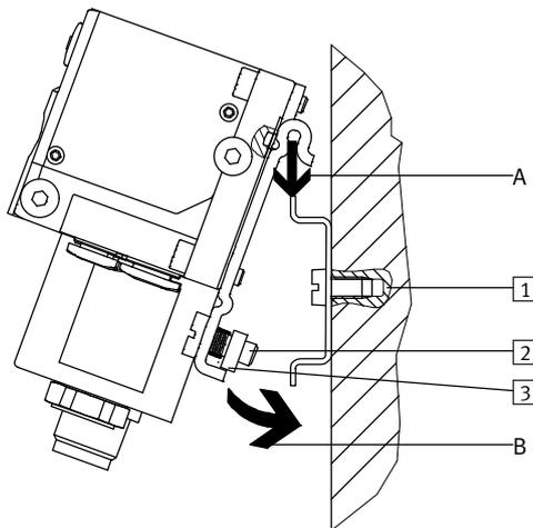
Die CPV-SC Ventilinsel wird in die Hutschiene eingehängt (siehe Pfeil A). Danach wird die Ventilinsel auf die Hutschiene geschwenkt und durch das Klemmstück befestigt (siehe Pfeil B).
