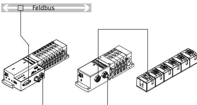
Die optionale Strangerweiterung bietet die Möglichkeit, weitere Ventilinseln und E/A-Module an den Busknoten der CPV-SC anzuschließen. Ein CP-Strang des Installationssystems CPI ist als Erweiterung in den Busknoten integriert. Es können verschiedene Ein- und Ausgangsmodule und CPV-, MPA-S-, CPV-SC-Ventilinseln angeschlossen werden.
