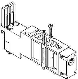
Mittels der Vertikal-Versorgungsplatte kann das einzelne Ventil unabhängig vom Betriebsdruck der Ventilinsel mit individuellem Betriebsdruck versorgt werden.
