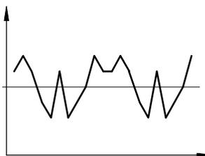
Wiederholgenauigkeit ist die Spanne, innerhalb derer die fluidische Ausgangsgröße streut, wenn dasselbe elektrische Eingangssignal, aus derselben Richtung kommend, wiederholt eingestellt wird. Die Wiederholgenauigkeit wird in % des maximalen fluidischen Ausgangssignals angegeben.
