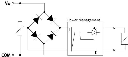
Jede MPA-Magnetspule ist mit einer Schutzbeschaltung zur Funkenlöschung und gegen Verpolung gesichert. Zusätzlich sind alle Ventiltypen mit einer integrierten Stromabsenkung ausgestattet.
