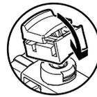
HHB mit Arretierung auf Vorsteuerventil aufclippen. Danach kann die Kappe der HHB rastend ohne Werkzeug betätigt werden.
