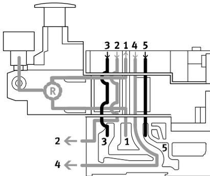
Dieser Druckregler regelt den Druck vor dem Ventil im Kanal 1. Dadurch haben die Kanäle 2 und 4 den gleichen geregelten Druck.
