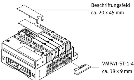
Zur Beschriftung der Ventile kann an jedem Anschlussblock mit 42 mm Baubreite ein Schilderträger VMPA1-ST-1-4 (Teile-Nr. 533 362, Code T im Bestellcode) oder VMPA1-ST-2-4 (Teile-Nr. 544 384, mit Beschriftungsschildern IBS-6x10 bestückbar) montiert werden.
