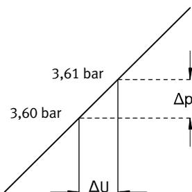
Wie feinfühlig man einen Druck verändern, d.h. einstellen kann, bestimmt die Ansprechempfindlichkeit des Gerätes. Die kleinste Sollwertdifferenz, die zu einer Änderung des Ausgangsdrucks führt, wird als Ansprechempfindlichkeit bezeichnet. Hier 0,01 bar.
