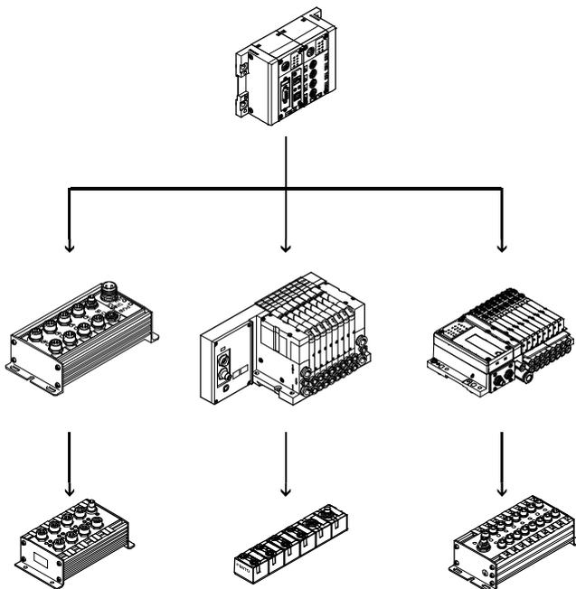
Ventilinsel für Installationssystem CPI:
