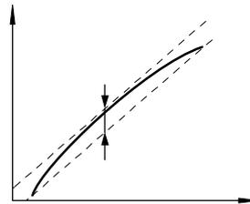
Der vollkommene lineare Verlauf der Regelkennlinie des Ausgangsdrucks ist theoretisch. Die maximale prozentuale Abweichung von dieser theoretischen Regelkennlinie nennt man Linearitätsfehler. Der Prozentwert bezieht sich auf den maximalen Ausgangsdruck (Full Scale).
