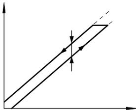
Zwischen dem eingegebenen Sollwert und dem ausgegebenen Druck besteht innerhalb einer Toleranz immer ein linearer Zusammenhang. Dennoch macht es einen Unterschied, ob der Sollwert ansteigend oder abfallend eingegeben wird. Die Differenz der maximalen Abweichungen nennt man Hysterese.
