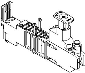
Für die Beeinflussung der Kraft des angesteuerten Aktuators kann zwischen Grundplatte und Ventil ein einstellbares Druckregelventil eingebaut werden. Dieses Druckregelventil hält den Ausgangsdruck (Sekundärseite) unabhängig von Druckschwän-
