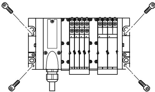
Die MPA Ventilinsel wird mit vier M4- oder M6-Schrauben auf der Befestigungsfläche angeschraubt. Die Montagebohrungen befinden sich am
