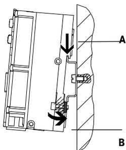
Die MPA Ventilinsel wird in die Hutschiene eingehängt (siehe Pfeil A). Danach wird die MPA Ventilinsel auf die Hutschiene geschwenkt und durch das Klemmstück befestigt (siehe Pfeil B).
