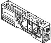
Bei erhöhtem Luftbedarf können zusätzlich mehrere Versorgungsplatten vorgesehen werden. Die Entlüftung erfolgt wahlweise über integrierte Flächenschalldämpfer oder Sammelanschlüsse für gefasste Abluft.
