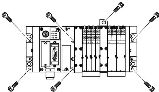
Die MPA Ventilinsel wird mit sechs M4- oder M6-Schrauben auf der Befestigungsfläche angeschraubt. Die Montagebohrungen befinden sich an der linken Endplatte (CPX) und an
