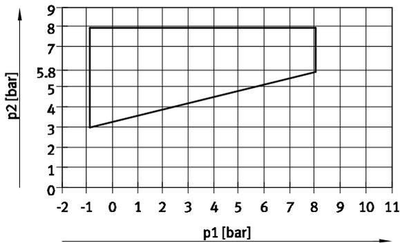
für Ventile in Baubreite 20 mm mit Code: MS, NS, KS, HS, DS
