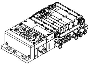
Integrierte Steuerungen in den Festo Ventilinseln ermöglichen den Aufbau von autarken Steuerungseinheiten (stand alone) in IP65 ohne Schaltschrank.
