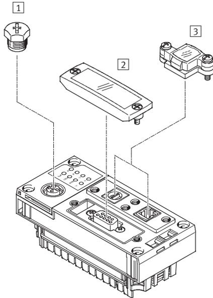
Abdeckungen werden in nicht benötigte Anschlüsse/Öffnungen eingesetzt/ingeschraubt bzw. aufgesetzt/aufgeschraubt.
