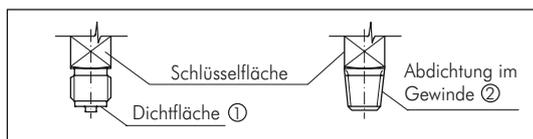
Das Anzugsmoment ist von der eingesetzten Dichtung abhängig. Um das Messgerät in die Stellung zu bringen, in der es sich am besten ablesen lässt, ist ein Anschluss mit Spannmuffe oder Überwurfmutter zu empfehlen. Sofern ein Druckmessgerät eine Ausblasvorrichtung besitzt, muss diese vor Blockierung durch Geräteteile oder Schmutz geschützt sein. Bei Sicherheitsdruckmessgeräten (zu erkennen am Ⓢ) ist darauf zu achten, dass der Freiraum hinter der ausblasbaren Rückwand mindestens 15 mm beträgt.
