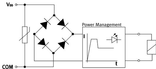
Jede Magnetspule ist mit einer Schutzbeschaltung zur Funkenlöschung und gegen Verpolung gesichert. Zusätzlich sind alle Ventiltypen mit einer integrierten Stromabsenkung ausgestattet.
