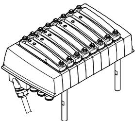
I-Port/IO-Link besteht aus einem zentralen Master und den über spezielle Verbindungsleitungen angeschlossenen Devices mit I-Port Schnittstelle/IO-Link. Hierdurch wird eine dezentrale Anordnung der Devices möglich. Die Verbindungsart entspricht einer Stern-Topologie.
