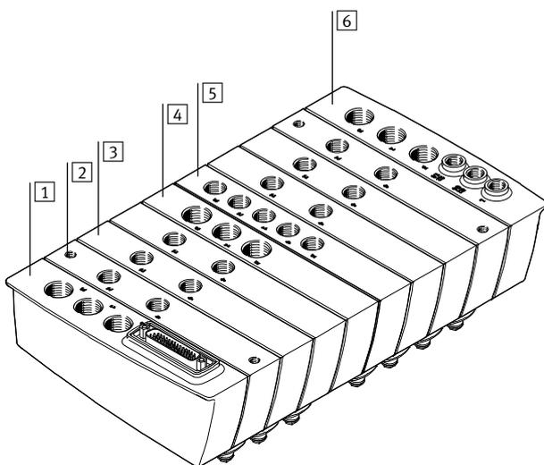
1 Linke Endplatte mit elektrischem Anschluss (Multipol oder I-Port Schnittstelle/IO-Link) und pneumatischen Anschlüssen 1, 3 und 5
