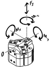
Die angegebenen zulässigen Kräfte und Momente beziehen sich auf einen Greifbacken. Sie beinhalten den Hebelarm, zusätzliche Gewichtskräfte durch das Werkstück bzw. durch externe Greiffinger und auftre-
