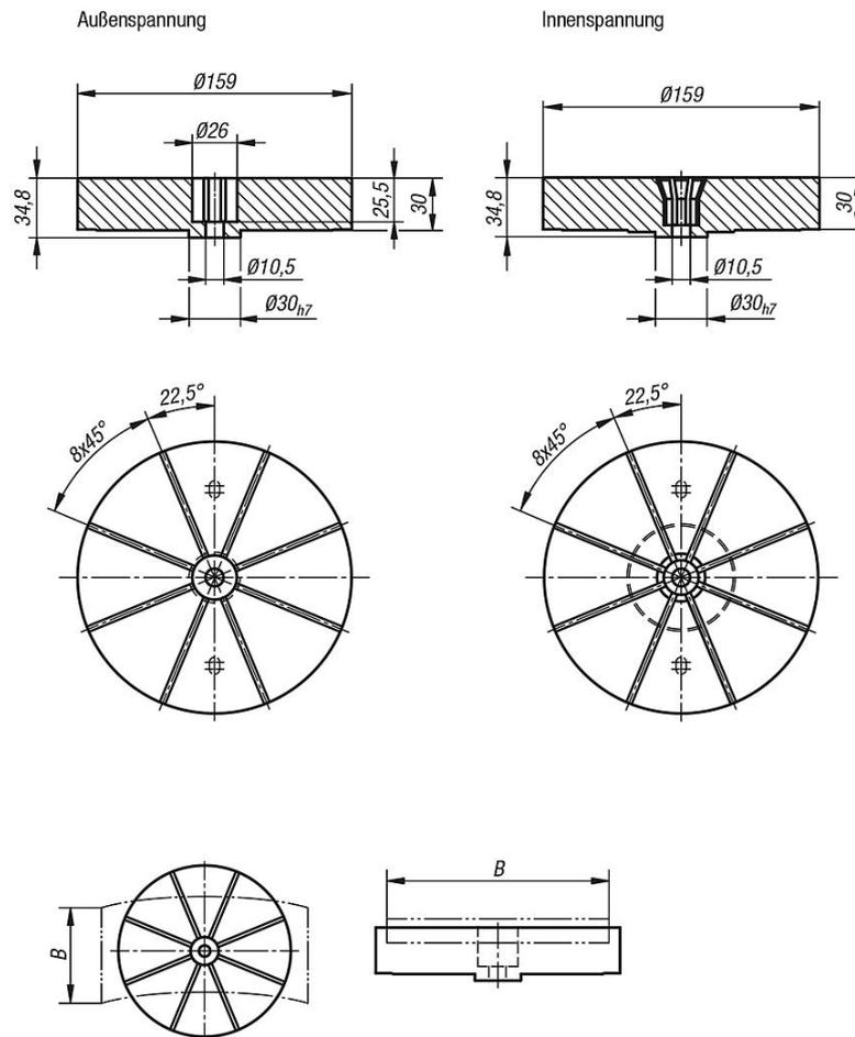
Die Werkstückbreite „B“ sollte maximal 90% des Spannanzendurchmessers betragen.
