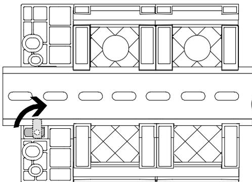
Im rückwärtigen Profil der (CPX-)Module ist die Hutschienenmontage eingepreßt. Über die Hutschienenbefestigungen lassen sich die Module auf der Hutschiene verriegeln.
