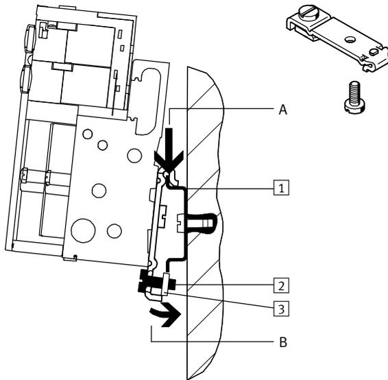
Die Ventilinsel wird in die Hutschiene eingehängt (siehe Pfeil A).
