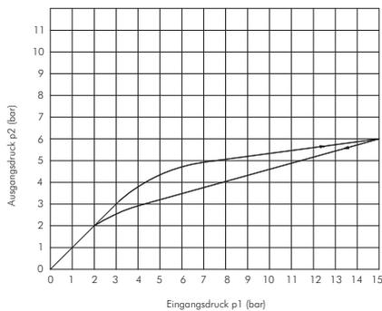
max. Durchfluss bei einem Eingangsdruck  $p_1 = 15\text{bar} = 405\text{ l/min}$
