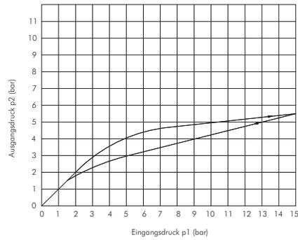
max. Durchfluss bei einem Eingangsdruck  $p_1 = 15\text{bar} = 390\text{ l/min}$
