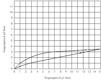
max. Durchfluss bei einem Eingangsdruck  $p_1 = 15\text{bar} = 360\text{ l/min}$
