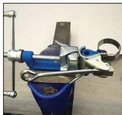
Spannen Sie das Spannwerkzeug in den Schraubstock ein. Setzen Sie den Adapter auf die Werkzeugnase. Führen Sie die Schelle in das Werkzeug ein. Halten Sie das Bandende mit dem Exenterhebel fest.
