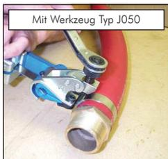
Mit Werkzeug Typ J001: Bewegen Sie einen Schneidhebel mit einem festen Ruck nach vorne, so dass das Bandende abgeschnitten wird.
