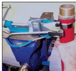
Stecken Sie den Schlauch durch die Schelle und drehen die Kurbel des Spannwerkzeuges nach rechts bis die gewünschte Spannung erreicht ist. Wenn sich das Band nicht mehr durch die Schlaufe zieht, ist die maximale Zugkraft erreicht. Die Bewegung des Bandes kann leicht durch Auflegen des Fingers „erfühlt“ werden.
