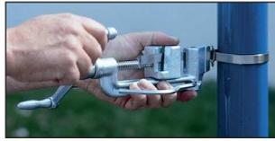
Band in das Spannwerkzeug seitlich einführen, Excenterhebel andrücken und durch Drehen der Kurbel Schelle anziehen. Die maximale Spannung ist erreicht, wenn das Band nicht mehr unter der Schleife durchzieht (lässt sich durch Auflegen eines Fingers leicht „erfühlen“).
