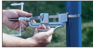
Nach Erreichen der erforderlichen Spannung das Werkzeug langsam über die Schleife biegen. Dabei gleichzeitig die Kurbel ca. eine halbe Umdrehung lösen, um Spannungsverlust und Reißen des Bands zu vermeiden. Um das Band abzuschneiden, Schneidhebel ruckartig ziehen.
