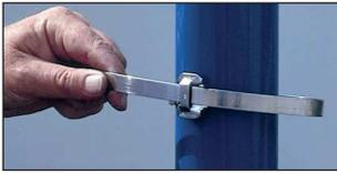
Schleife mit den Ohren zum Bandende auf das Band ziehen. Schelle formen und Band auf Band legen. Schleife über beide Bänder ziehen und das Bandende ca. 30 mm unter die Schleife biegen. Bei hoher Belastung der Schelle (z. B. bei Schlauchbindung) Band zweimal durch die Schleife ziehen.
