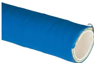
**Werkstoffe:** Innenseele: NBR, weiß, glatt, lebensmittelecht entsprechend den Anforderungen BfR (ehem. BgVV) XXI Kat-2, FDA CFR 21 177.2600 & Verordnung (EG) 1935/2004, fett- und ölbeständig, Druckträger: Textileinlagen gewickelt, Stahlspirale verzinkt, Außendecke: NVC, abriebfest, alterungsbeständig, Stoffimpression
