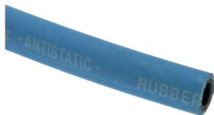
**Werkstoffe:** Innenseele: NBR/SBR schwarz, glatt, antistatisch, Außendecke: SBR/EPDM, glatt, abrieb-, witterungs- und ölbeständig, Gewebeeinlage: spiralisierte, synthetische Textilfäden
