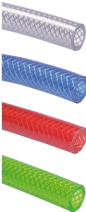
**Werkstoffe:** Innenseele und Außendecke: PVC, Gewebeeinlage: Textil, TÜV-geprüft, LABS-freie Produktion, Lebensmittelqualität geprüft entsprechend den Anforderungen der Verordnung (EG) 1935/2004 und der Verordnung (EU) 10/2011 (Simultanen A, B und C) und FDA 21 CFR 175.300 (Typ leuchtgrün: nicht TÜV-geprüft und nicht FDA 21 CFR 175.300).
