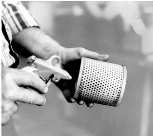
Abb. 2.18: Reinigung des Trockenluftfilters
