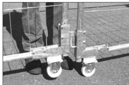
Durch 2 Wandhalter lässt sich ein Bauzaunelement an der Wand montieren.
