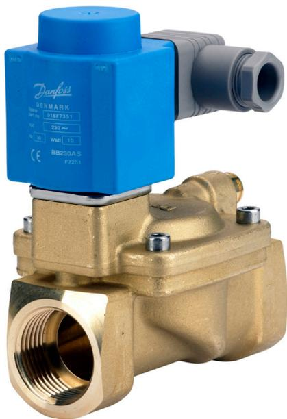
Die Baureihe EV220B 15–50 gehört zu einem universellen indirekt servogesteuerten 2/2-Wegeventil-Programm. Dank des Ventilgehäuses aus Messing, entzinkungsbeständigem Messing oder Edelstahl kann eine Vielzahl von Anwendungszwecken abgedeckt werden. Standardmäßig eingebauter Ringfilter, einstellbare Schließzeit und Gehäuse mit Schutzart bis IP67 garantieren optimale Funktion auch unter kritischen Betriebsbedingungen.
