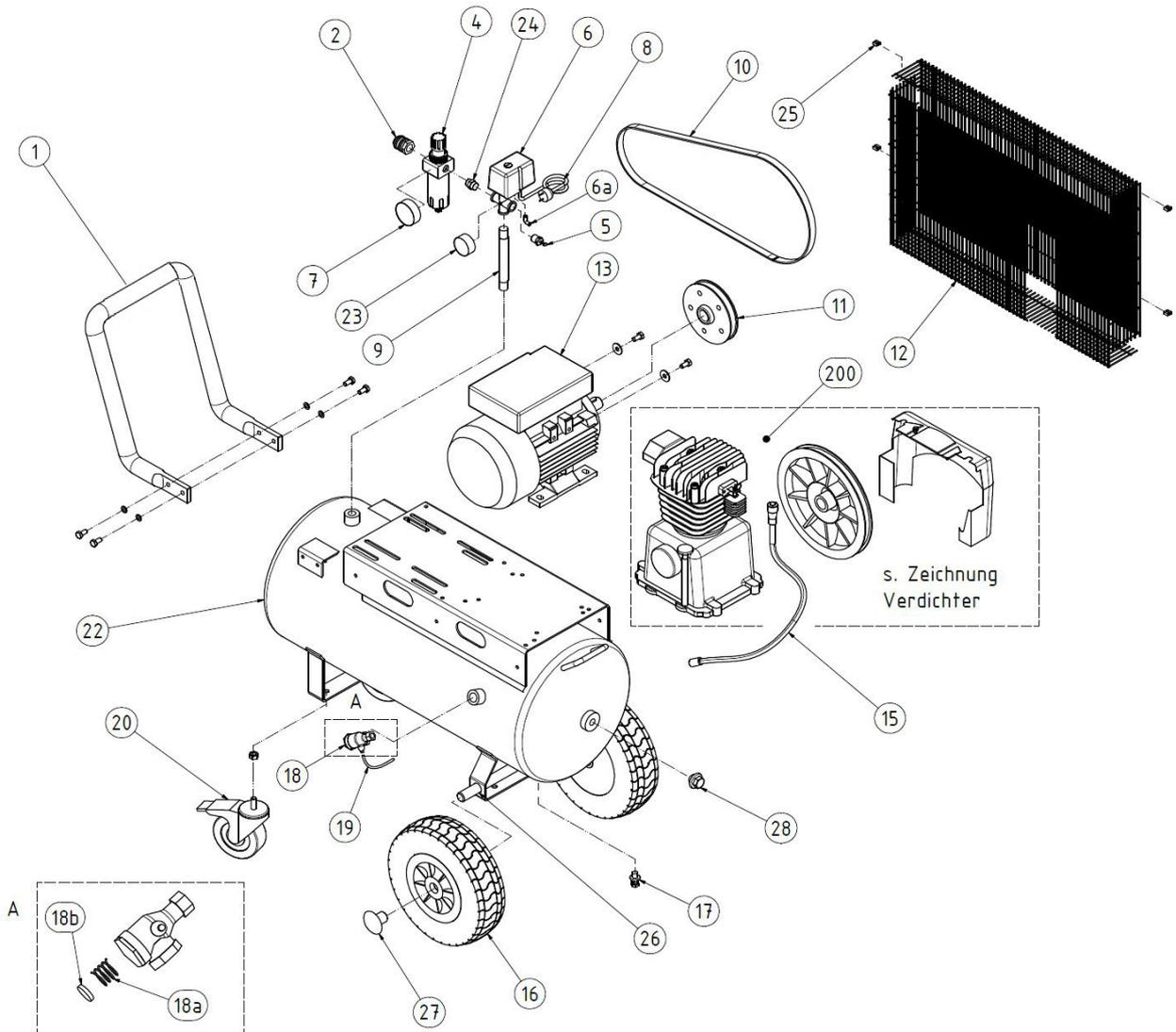
Abb. / Fig. 1: Ersatzteile / Spare parts drawing AIRSTAR 401/50, 401/100, 403/50 & 403/100
