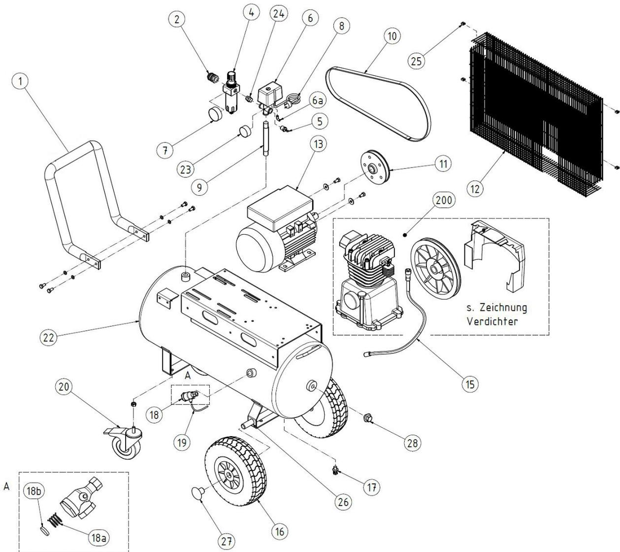
Abb. / Fig. 3: Ersatzteile / Spare parts AIRSTAR 503/50 & 503/100
