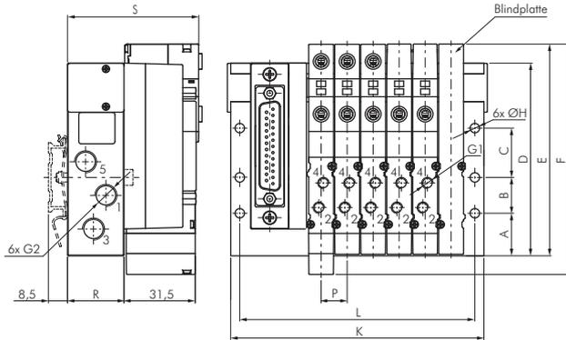
Ventilterminal mit Anschlussplattenventilen
