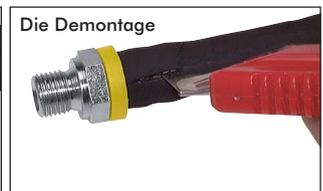
Schlauch mit einem Messer seitlich aufschneiden, dabei die Nippelrippen nicht beschädigen - Leckagegefahr!
