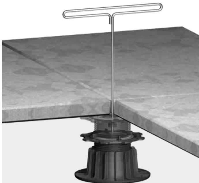
Altura regulable con la llave de ajuste durante el montaje (para un máx. de 3 losas de piedra). Solo hay que insertar la llave a través de la junta y ajustar la altura deseada.
