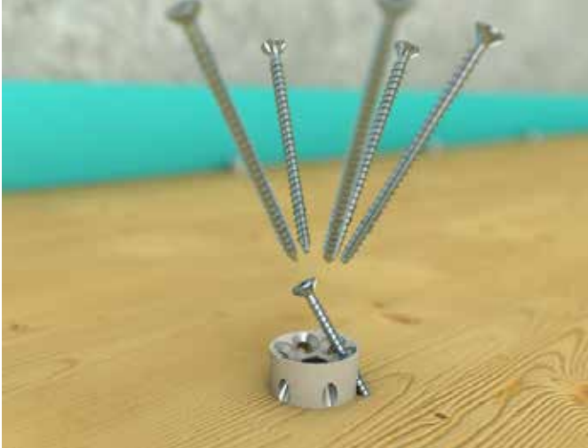
Paso 3: Inserte los seis tornillos KonstruX de 6,5 mm x 100 mm en cada agujero del cilindro metálico, ajustando uno por uno en forma gradual para evitar que el cilindro se salga de posición.
