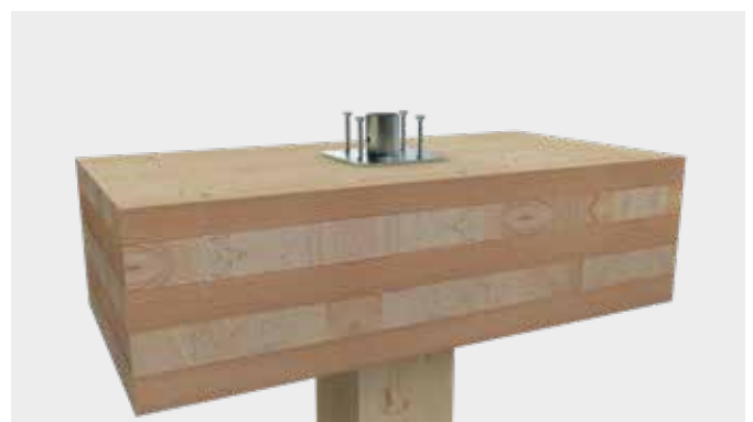
Paso 6: Fijación de la placa de presión arriba en el elemento de techo con los tornillos KonstruX (B) suministrados.
