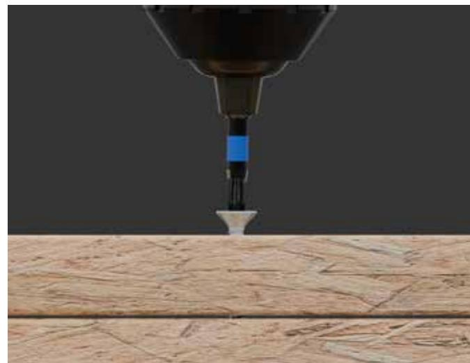
En cuanto se engancha la rosca bajo la cabeza, los componentes se unen durante el proceso de atornillado.
