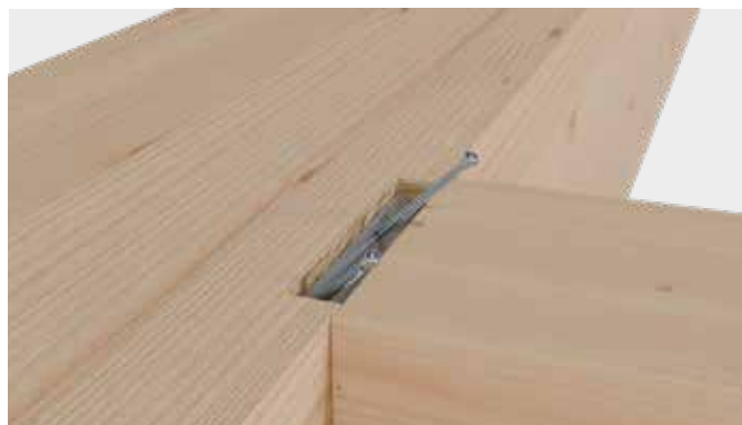
Paso 4: por último, fije el Connecto con los tornillos de bloqueo suministrados ( \varnothing 5 mm).
