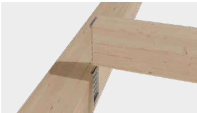
Paso 3: enganche la viga secundaria de arriba abajo. Asegúrese de que las dos piezas del Connecto estén alineadas en paralelo entre sí para evitar una tensión excesiva durante el montaje.
