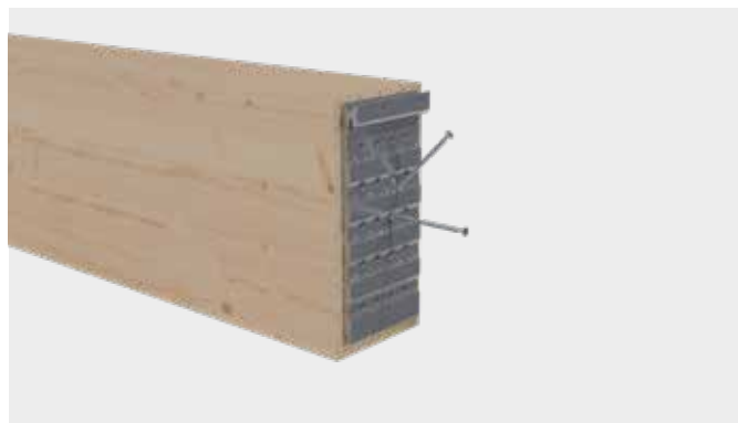
Paso 2: coloque el Connecto en la viga secundaria y apriete los tornillos.
