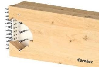
Caso 1: Altura del soporte principal = Altura del soporte secundario patrón de tornillos mínimo permitido
