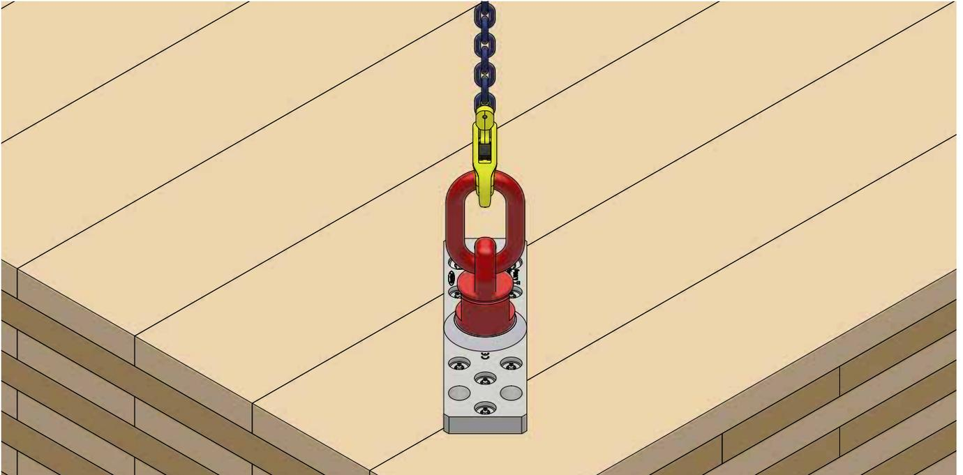
**Paso 3:** Enganche el Powerblock en el ángulo previamente determinado (véanse los datos técnicos) y levántelo.
