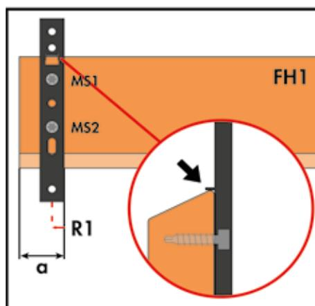
**CONSEJO DE EXPERTO:** Dibuje la distancia  $a$  y simplemente apoye el clip para fachadas con su canto en la línea para, a continuación, atornillarlo con firmeza. De este modo, se ahorrará la tarea de medir los 7,4 mm.
