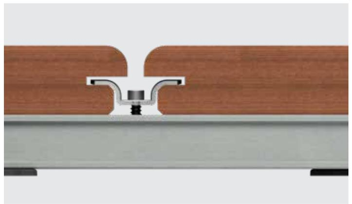
El V-Clip en el pavimento de una terraza con ranura asimétrica.
