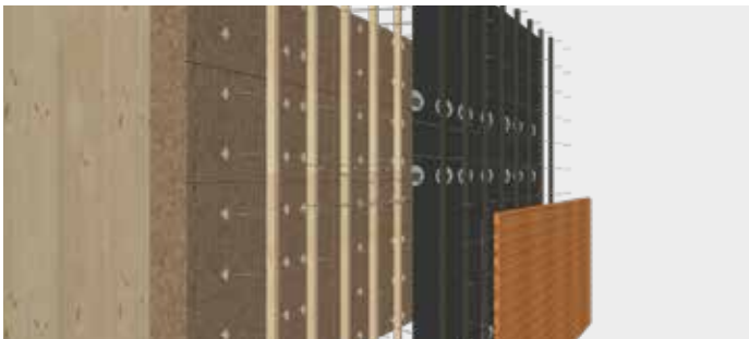
Fijación de fachada mediante listones de madera dispuestos verticalmente y tornillo para techos Topduo
