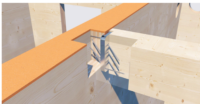
Conector de gancho Magnus para el montaje de una viga en una pared.
