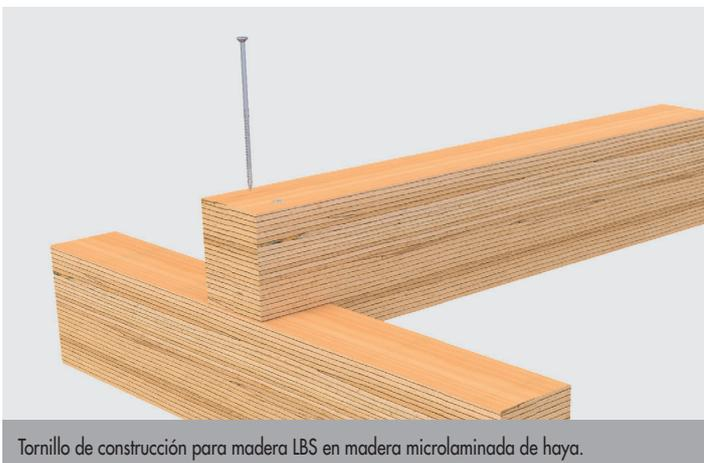
Tornillo de construcción para madera LBS en madera microlaminada de haya.
