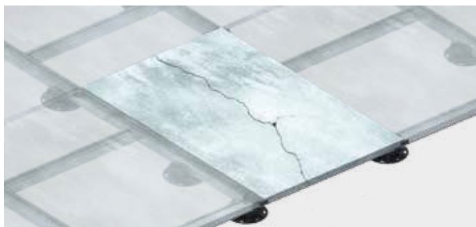
Увеличение риска разлома отдельных пластин из-за отсутствия опорных профилей
