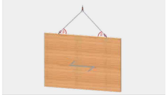
Стена или балка из клеёной древесины в лежачем положении, направление волокон: горизонтальное
