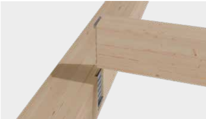
Krok 3: Wpiąć belkę drugorzędną od góry do dołu. Uważać, aby części Connecto ustawione były równolegle do siebie, ponieważ inaczej mogłyby zostać poddane nadmiernemu naprężeniu podczas montażu.
