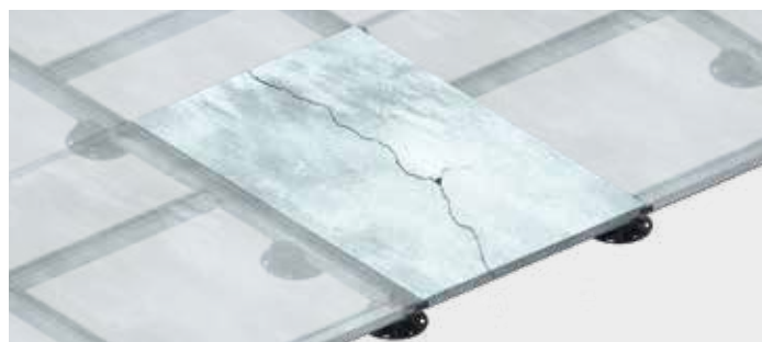
Zwiększone ryzyko pęknięcia poszczególnych płyt z powodu braku profili podpierających
