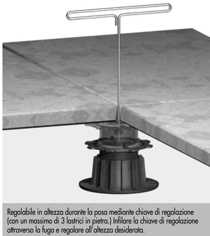
Regolabile in altezza durante la posa mediante chiave di regolazione (con un massimo di 3 lastrici in pietra.) Infilare la chiave di regolazione attraverso la fuga e regolare all'altezza desiderata.
