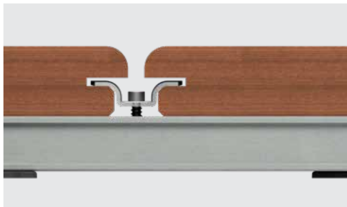
La V-Clip in un rivestimento di terrazza con scanalatura asimmetrica.
