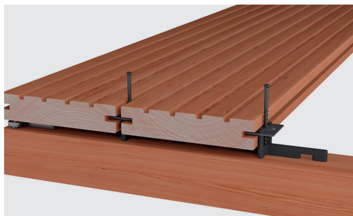
La punta a T consente di mantenere una distanza uniforme tra le tavole.
