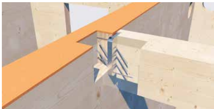
Connessione a incastro Magnus per il montaggio di una trave su una parete.
