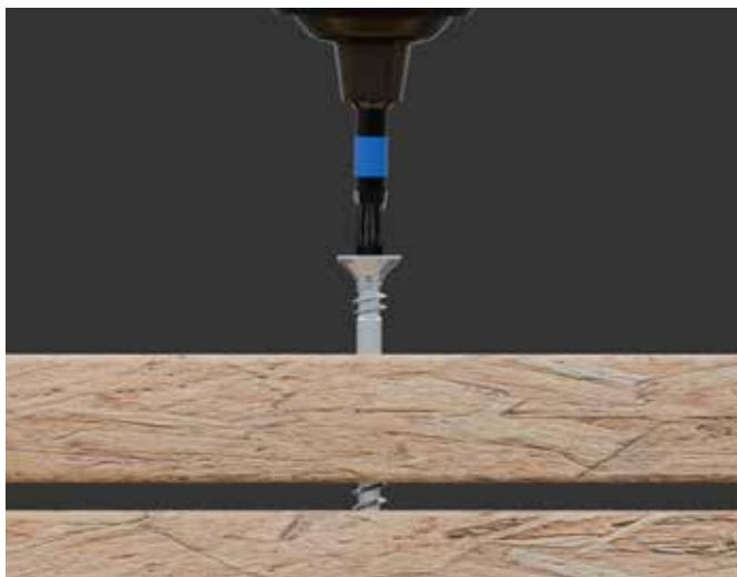
La mancanza di un fissaggio preliminare crea fessurazioni fra i componenti durante l'avvitamento.
