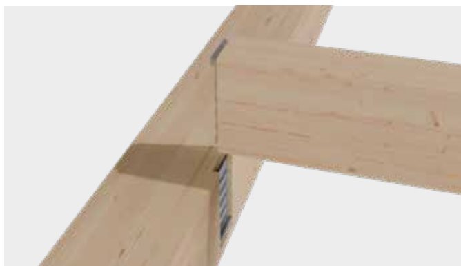
Fase 3: Agganciare la trave secondaria dall'alto verso il basso. Assicurarsi che entrambi i componenti Connecto siano allineati parallelamente l'uno all'altro per evitare un'eccessiva tensione durante l'assemblaggio.
