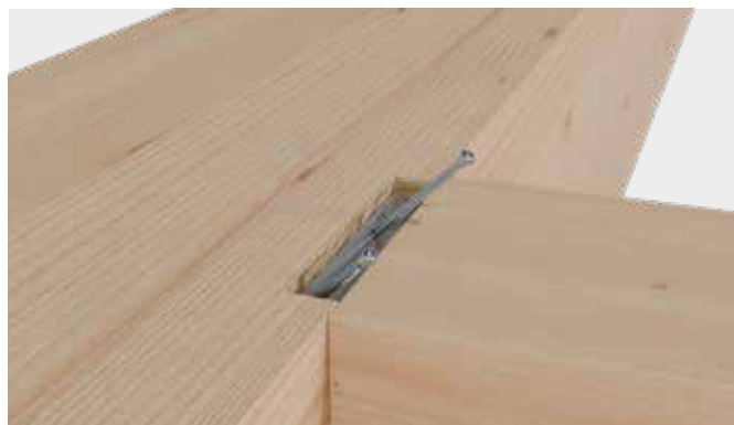
Fase 4: Infine, fissare Connecto con le viti di serraggio comprese nella fornitura (Ø 5 mm).
