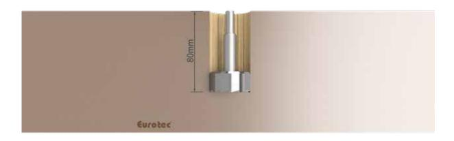
1.2. Con uno spessore di materiale > 80 mm, perforare fino a una profondità di 80 mm.
