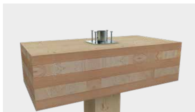
Étape 6 : fixation de la plaque de pression à l'élément de plafond en haut à l'aide des vis KonstruX jointes (B).
