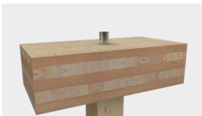
Étape 5 : mise en place de l'élément de plafond.
