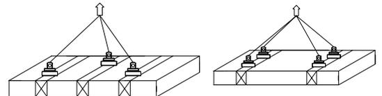
Le pin et le mélèze, et les panneaux BSP où l'accrochage est de face, ne doivent être soulevés que sous un angle  $\geq 5^\circ$  par rapport à l'axe du trou de perçage.
