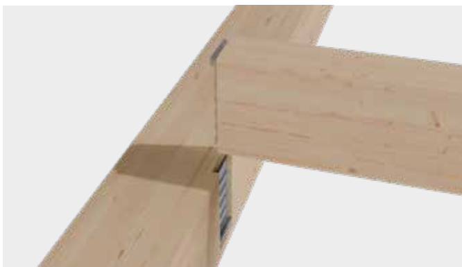
Étape 3 : Accrochez la poutre secondaire de haut en bas. Assurez-vous que les deux parties du Connecto sont alignées parallèlement l'une à l'autre afin d'éviter toute contrainte excessive pendant le montage.
