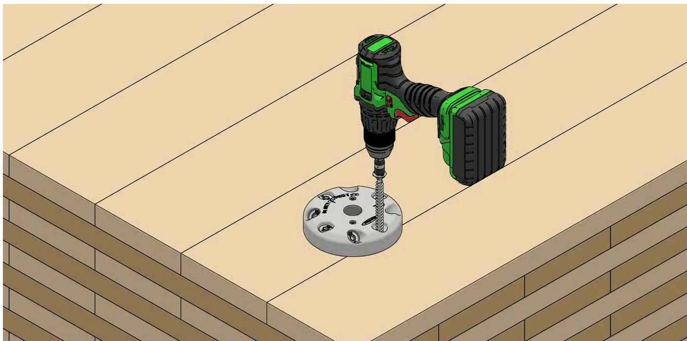
*2e étape : visser les vis KonstruX assorties en fonction de la configuration (voir données techniques).*
