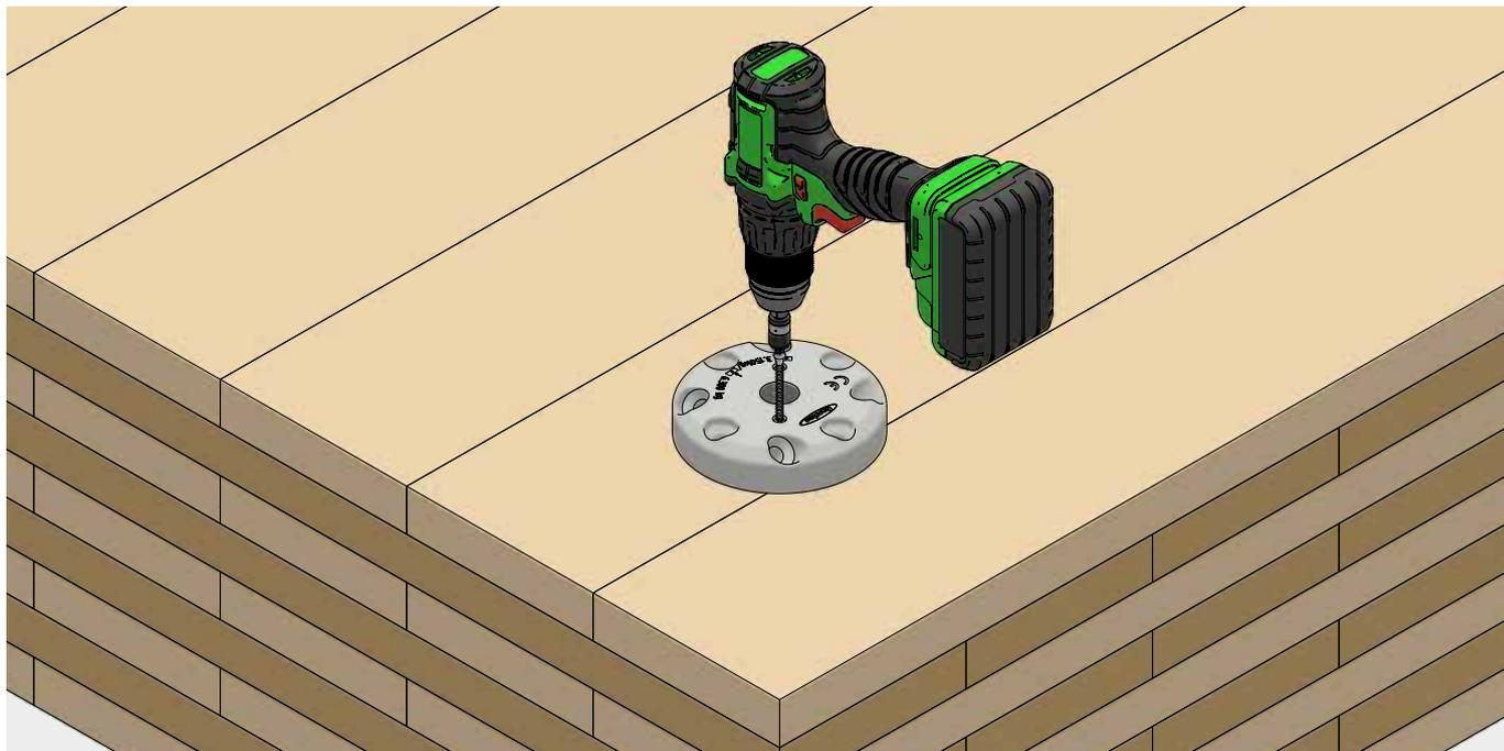
*1ère étape : positionnez dûment le bloc d'ajustage circulaire Power en respectant les écarts minimaux et fixez le à l'aide des vis correspondantes (vis pour équerre).*
