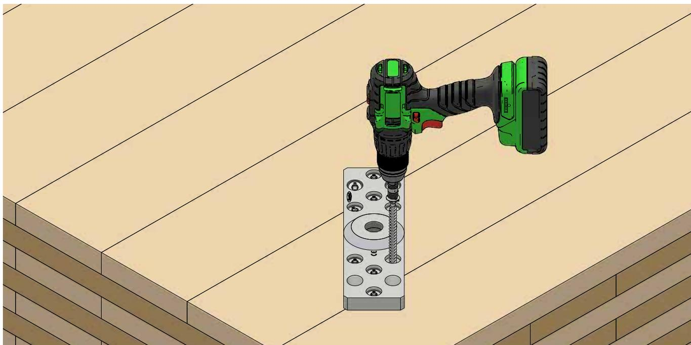
1<sup>ère</sup> étape : visser les vis KonstruX adaptées en fonction de la configuration (voir caractéristiques techniques).
