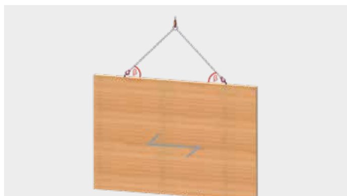
Mur ou poutre en bois lamellé collé en position dressée, orientation des fibres : verticale
