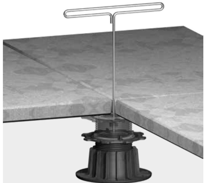
Réglable en hauteur avec clé de réglage lors de la pose (avec 3 dalles en pierre au maximum) Il suffit d'insérer la clé de réglage dans le joint et de régler à la hauteur souhaitée.
